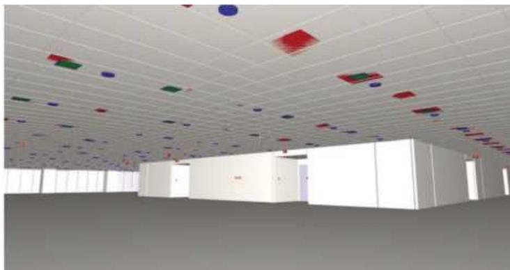
図8 BIMモデルを利用した電気・空調・防災設備の位置の検討
