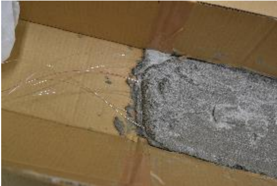
図8：ポリマー光ファイバーを埋没させたコンクリート平板。
