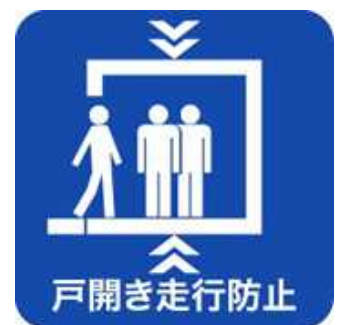
戸開走行保護装置設置済みマーク
