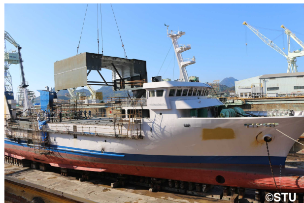
▲船上劇場部分搭載工事の様子
