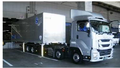
【スワップボディコンテナ車両】 (出典：国土交通省生産性革命プロジェクト(第4版))
