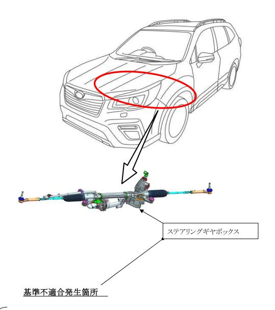
電動パワーステアリングにおいて、コントロールユニットの端子部の製造条件が不適切なため、回路が絶縁されずに導通するものがある。 そのため、警告灯が点灯するとともにパワーステアリングのアシスト機能が停止し、ステアリングの操作力が増大するおそれがある。
