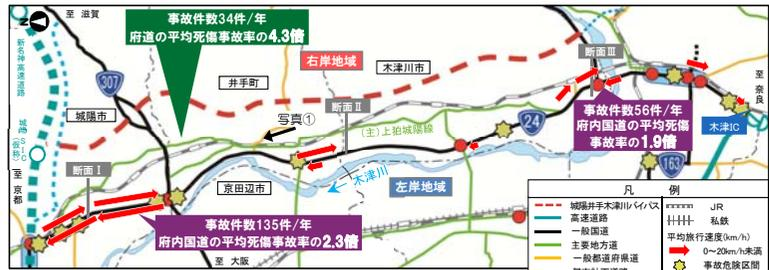
図4 右岸地域の速度低下状況及び死傷事故率
