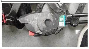
ワイヤー巻き取りが完了前に高速で走行することにより、地面にリール本体が繰り返し打ち付けられることでリール本体が破損する。
