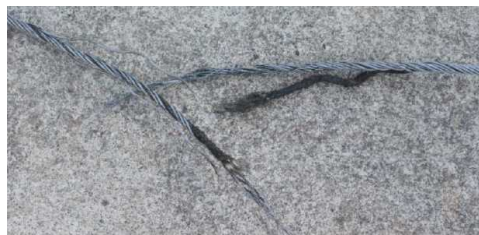
写真2 破断したドアワイヤ（事故機）
