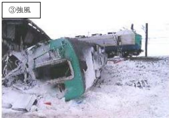
図 2-2 自然災害による鉄道の被災事例
