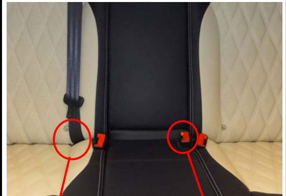
スタッドボルト取付け位置（シート裏側）
