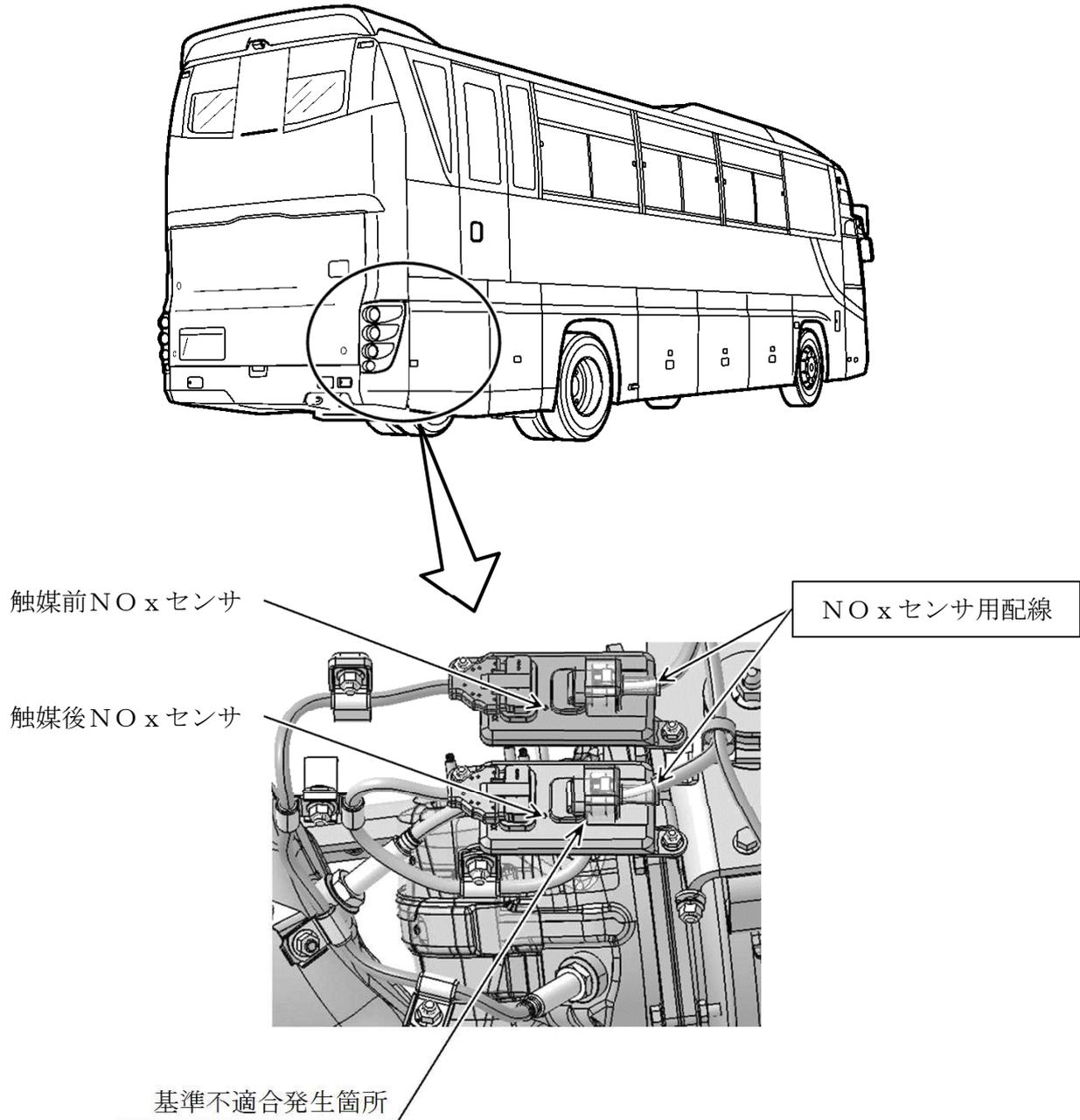
大型観光バスの排出ガス発散防止装置において、NO<sub>x</sub>センサ用配線の接続指示が不適切なため、触媒前後の配線が逆接続されている。そのため、排出ガス発散防止装置が正しく作動せず、排出ガスが保安基準を満足しないおそれがある。
