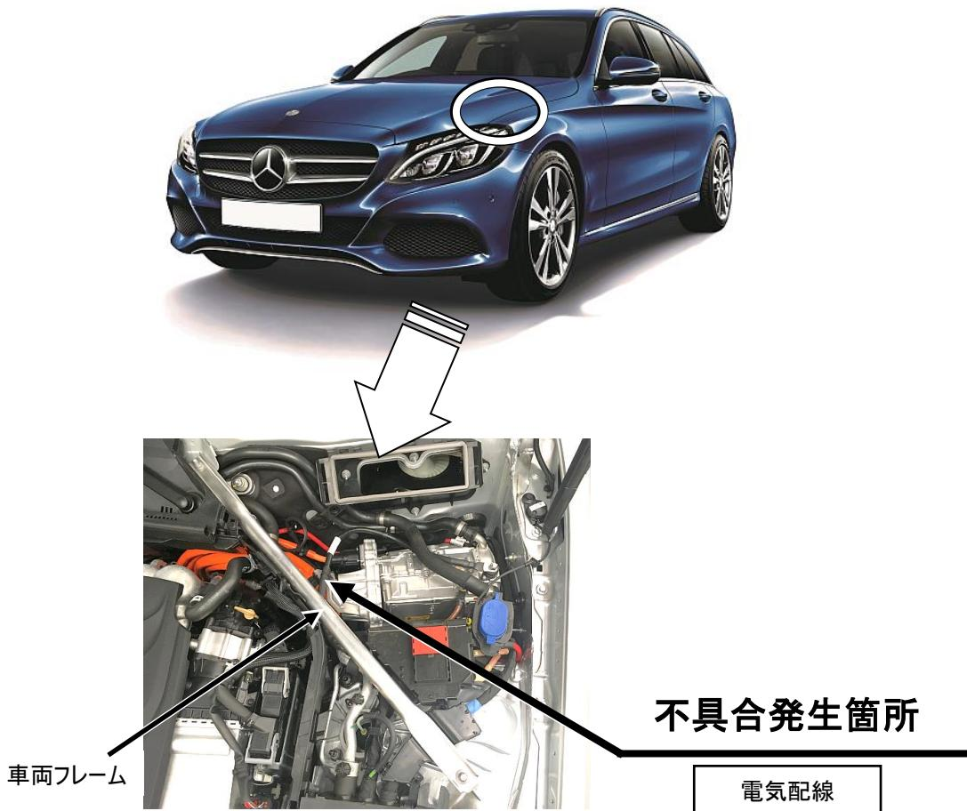
注：□は、点検し干渉がある場合は、適切な配策へ修正、被覆が削れている場合は、交換を行う部品を示す。
