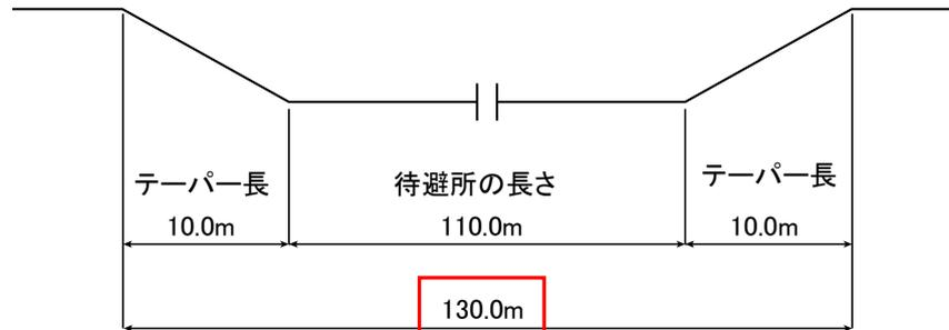
図 除雪車待避所の平面形状
