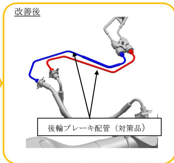
車いす乗降用スロープ装着車において、後輪ブレーキ配管の配索設計が不適切なため、当該配管が誤って配索されている。そのため、旋回時などに車両が横滑りした際に横滑り防止装置が正しく機能せず、最悪の場合、走行安定性を損なうおそれがある。
