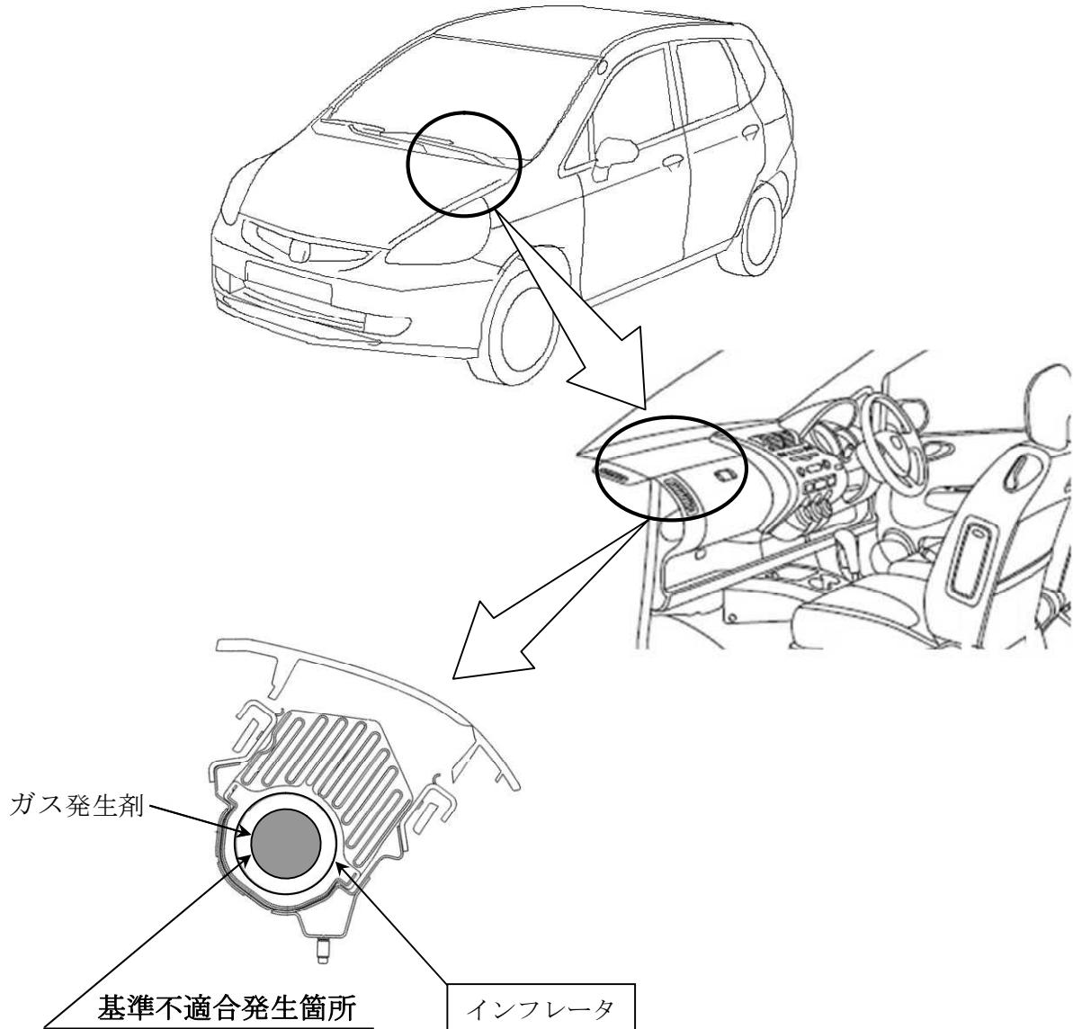
助手席側のエアバッグのインフレータ（膨張装置）において、環境温度および湿度変化の繰り返しによりガス発生剤が劣化することがある。そのため、エアバッグ展開時にインフレータ内圧が異常上昇して、インフレータ容器が破損するおそれがある。
