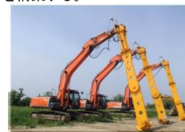
WILL工法改良機
