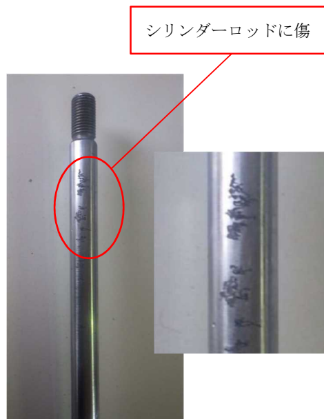
写真6 シリンダーロッドの傷
