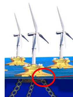
係留ラインからの反力を受ける箇所の例
