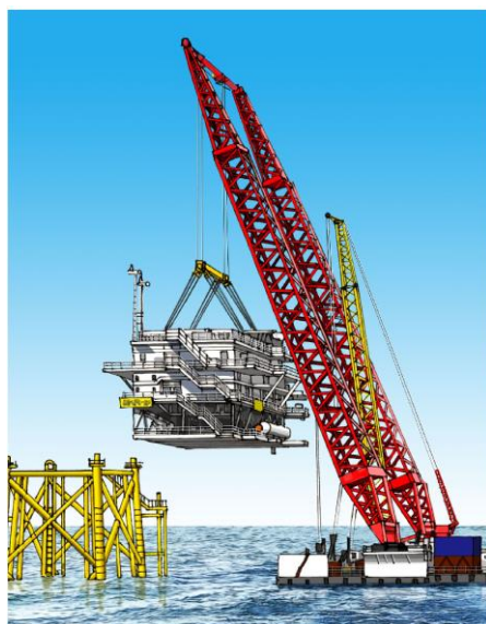
図 3-7 サブステーションの施工イメージ
