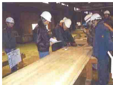
県産材での試験体仮組製品検査
