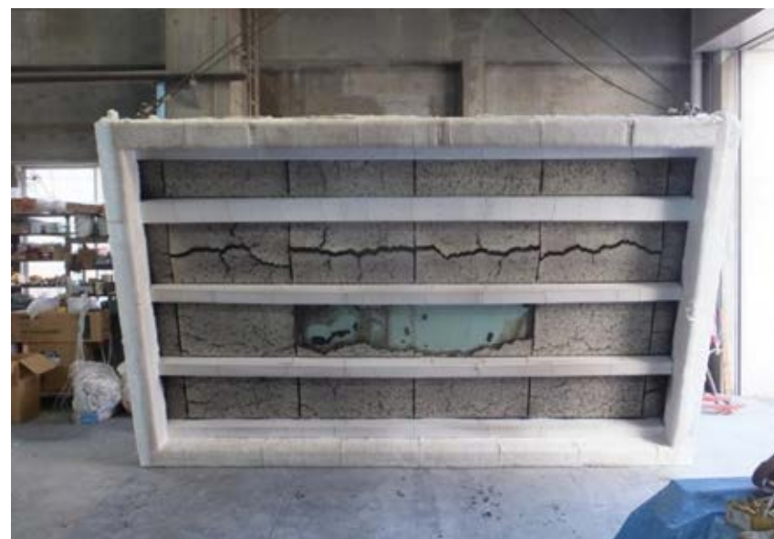
試験後の加熱面の状況
