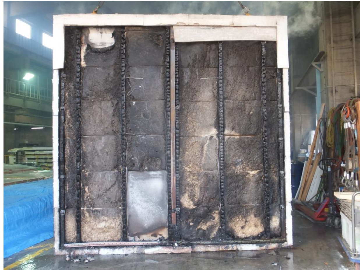
木下地 加熱側表面(加熱後)
