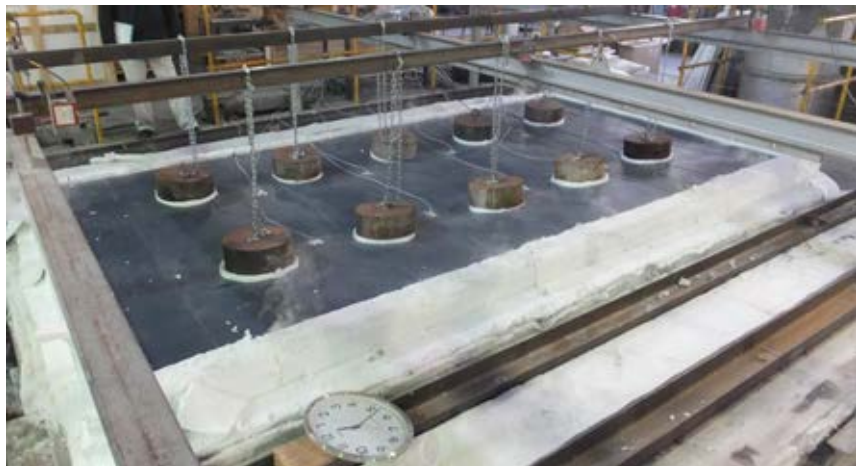
試験体(野地板の亀裂割れ発生時28分)
