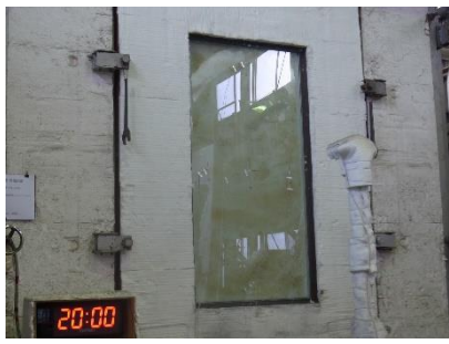
加熱20分：水ガラス白濁。裏面温度の上昇は小さい。
