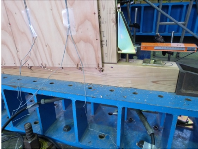
1/15rad 柱脚部状況
