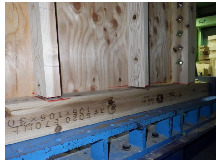
1/15rad 柱脚部変形状況
