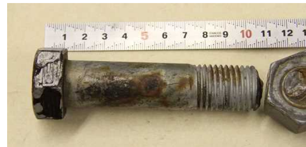
写真5 折損したボルト
