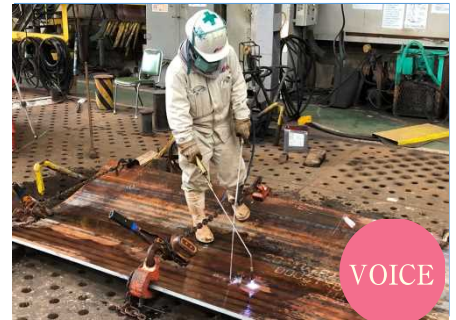
鉄工グループに所属し、歪取りやぎょう鉄(鋼板曲げ加工)作業を担当している上田さん(13年目)高い精度を求められるこの仕事で本人の能力が発揮されています。
