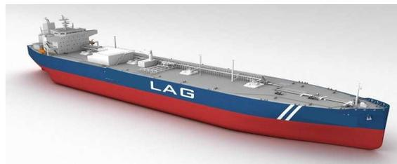
(参考)液体アンモニア積載量: 約38,300 m<sup>3</sup>
