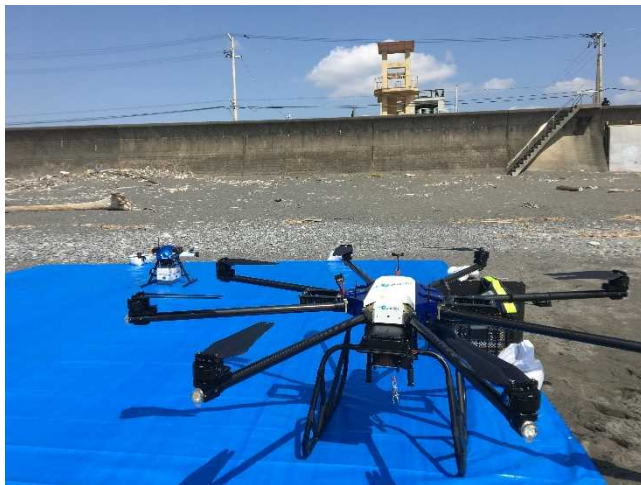
赤岡海浜よりドローンが自動飛行し、津波避難タワー屋上のドローンポートへの輸送(CiDroneTR-52)
