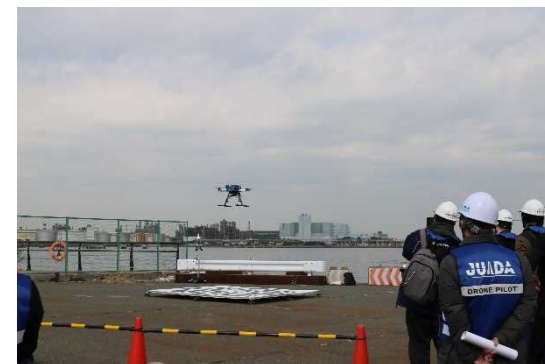
川崎港南防波堤に設置したドローンポートに、GPSとビジョンセンサーにより自動着陸を試みるドローン(PF2)
