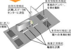
▲自動重量計測装置
