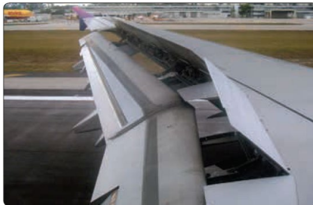
図6-19. スポイラーは、降下時および着陸時の揚力を低下させ、抗力を増加させる。
