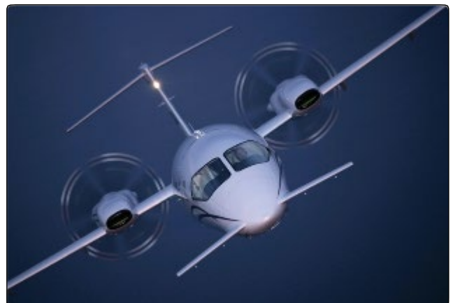
図 6-14. Piaggio P180には、横軸周りの縦方向の安定性を提供する可変スweep先尾翼設計が含まれている。
