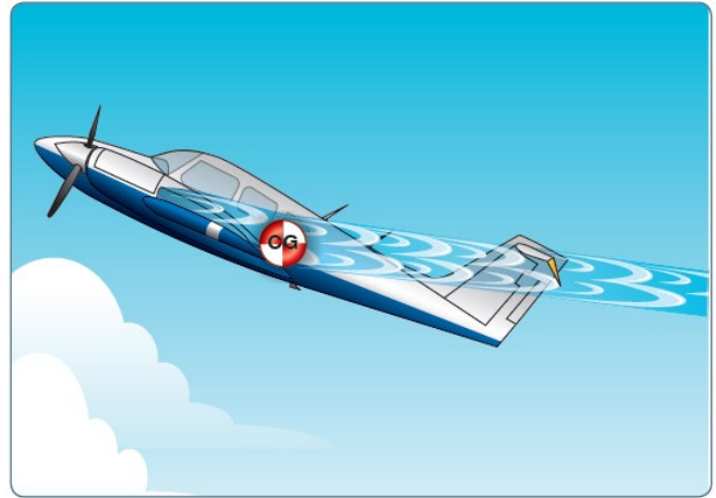
図 6-11. 高AOAおよび後部CGのT型尾翼デザインの航空機
