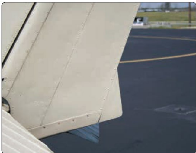
図 6-22. 痴情調整可能なタブは、多くの小型飛行機の方向舵に使用され、胴体が相対風とわずかにずれて飛行する傾向を修正する。
