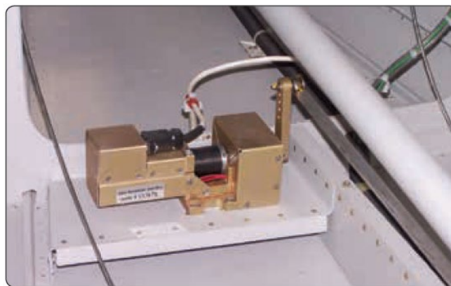
図 6-24. 飛行制御システムに統合された基本的な自動操縦システム
