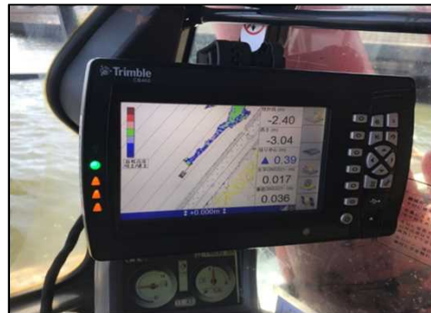
バックホウに搭載したICT機器
