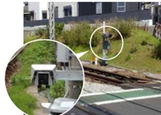
二次元式踏切障害物検知装置
