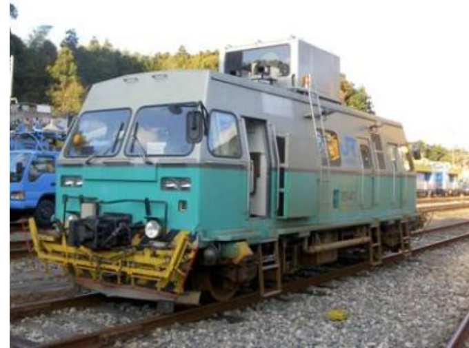
高速確認車 (始発列車運行前に保守作業終了線路支障の有無を確認)
