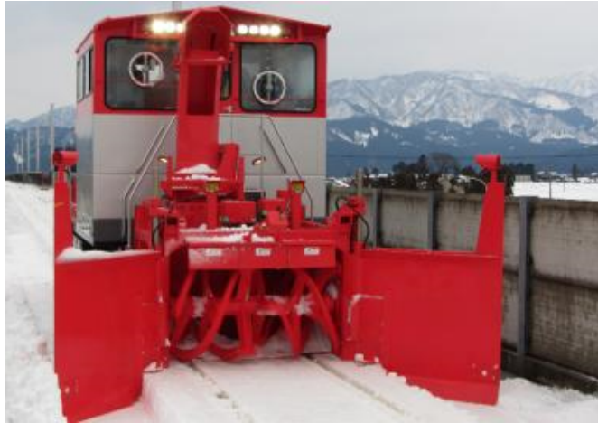
除雪車 (降雪時に軌道等に堆積した雪を除去)
