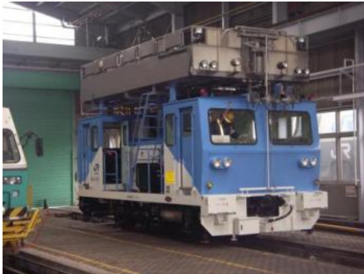
電気保全車 (電車線路設備の点検、修繕)
