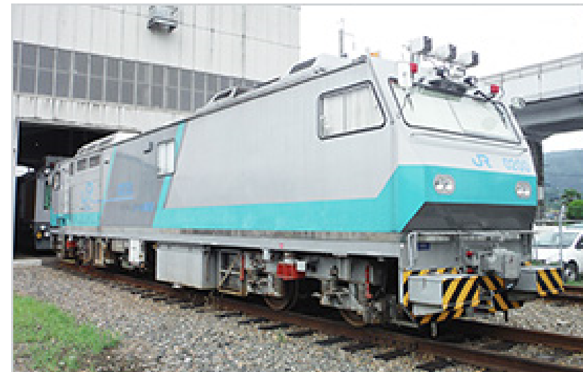
レール探傷車 (レールの傷、摩耗の検査・測定)
