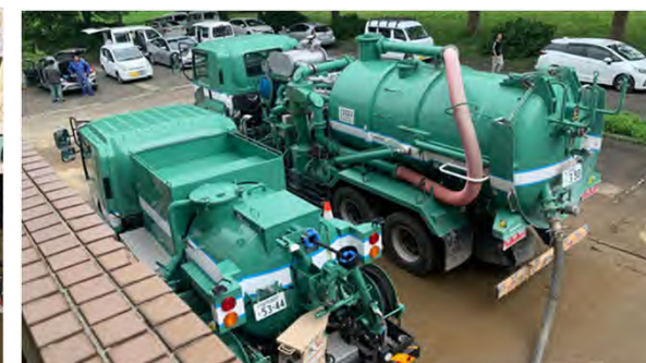
バキューム車による応急対応
