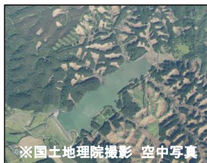
※国土地理院撮影 空中写真 【早来地区】瑞穂ダム 貯水池内への土砂、倒木流入
