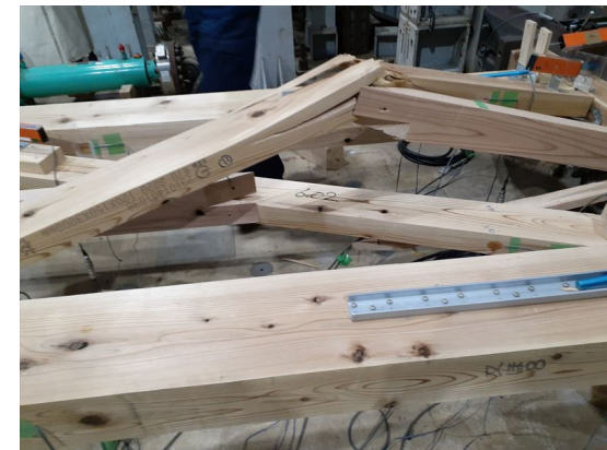
1/13.5rad 下段の筋かいの座屈
