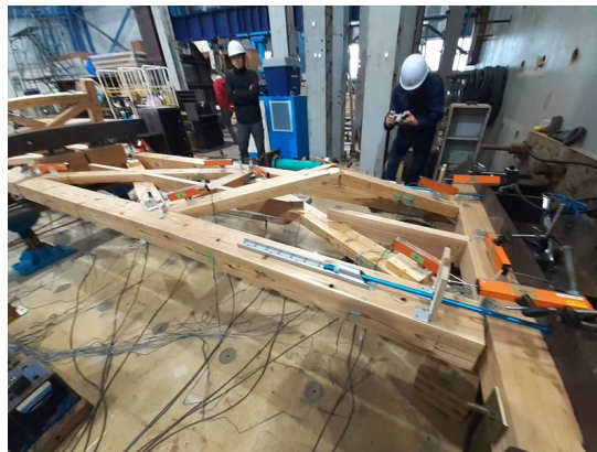
1/11.7rad 下段の筋かいの座屈
