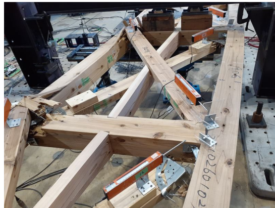
1/8.2rad 下段・中段筋かいの状況
