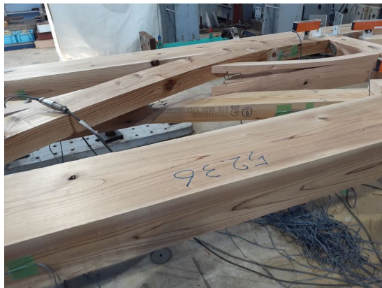
1/21rad 中段の間柱折損
