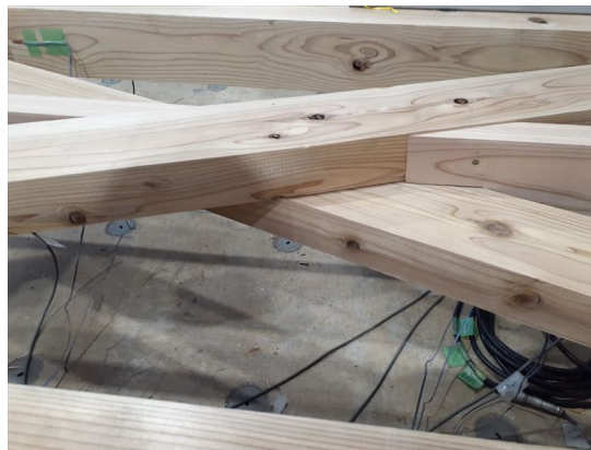
1/50rad 筋かいの変形
