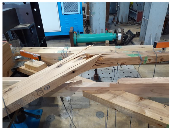
1/11.7rad 中段の筋かきの座屈
