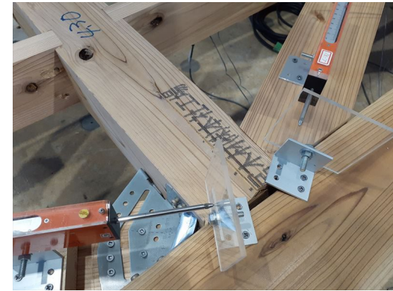
1/15rad 下段筋かい端部
