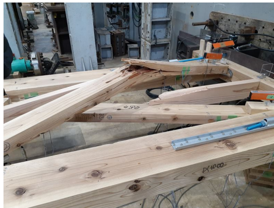
1/13rad 下段の筋かいの座屈
