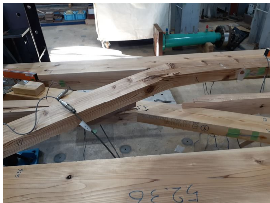
1/20rad 中段の圧縮筋かい座屈
