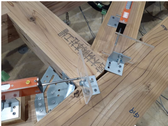
1/15rad 筋かい端部のめり込み
