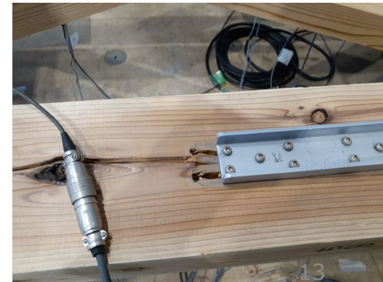
1/10.4rad 非加力側HDの破壊
