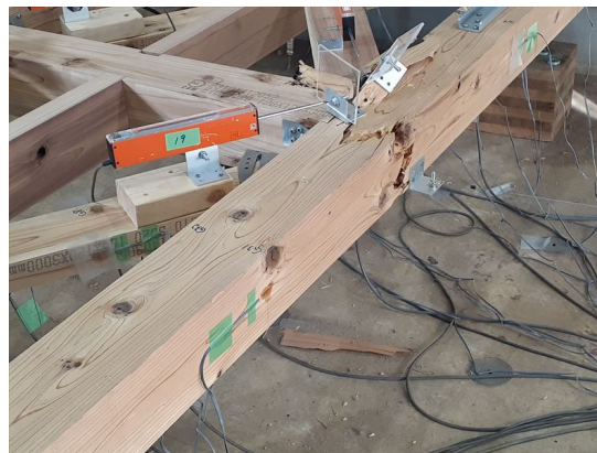
1/11.6rad 非加力側柱の引張破壊
