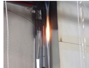
④ 試験体No.7 枠と枠の隙間から火炎確認→保護材を無しとしたことが原因
