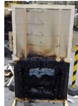
S6 FS:通気 金物+加 熱発泡材 上階: PUF
