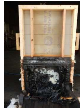
S5 FS:通気 金物+加 熱発泡材 上階部:無断熱
