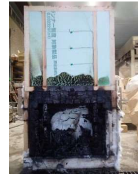
S7 FS:通気 金物+加 熱発泡材 上階: XPS
