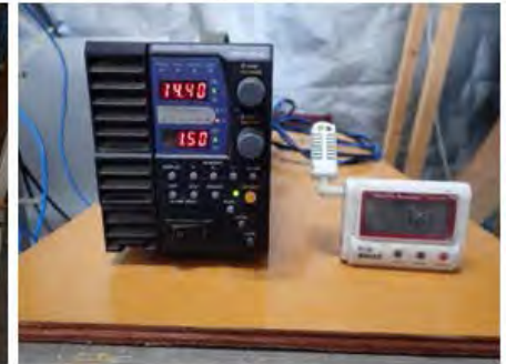
直流電源装置
