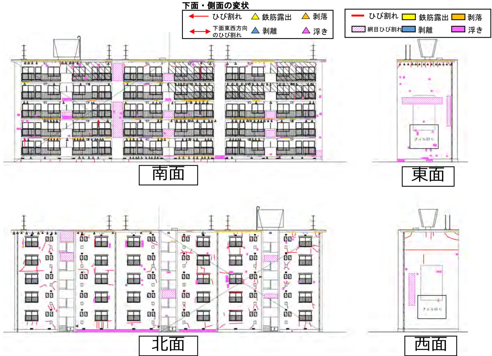
図-5.1 目視および打診調査結果 (地点B-2)
