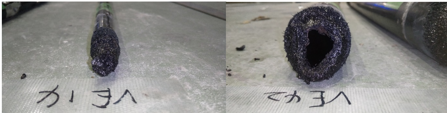
写真 硬質塩化ビニル管の溶融・発泡状況
