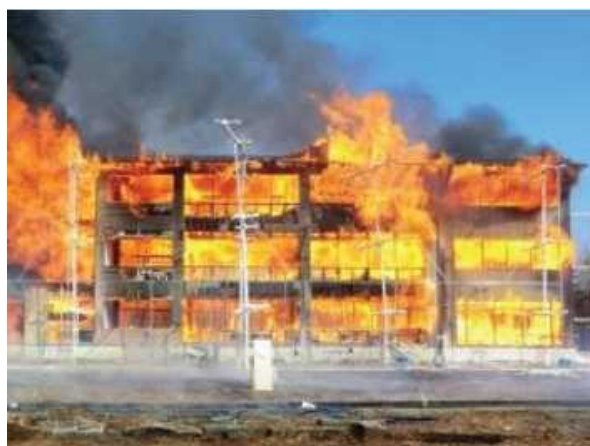
木造3階建て学校の実大規模の火災実験 (国立研究開発法人建築研究所のホームページより)
