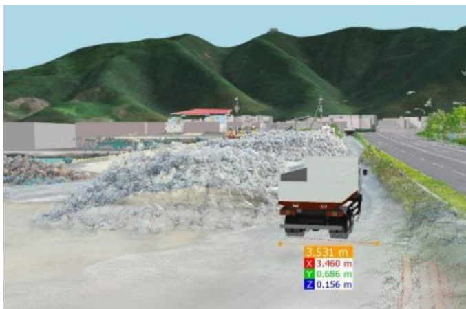
障害物との離隔確認
