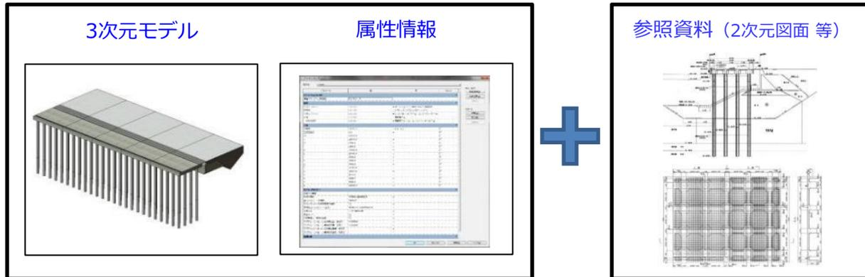
図 2-9 構造物モデルの例
