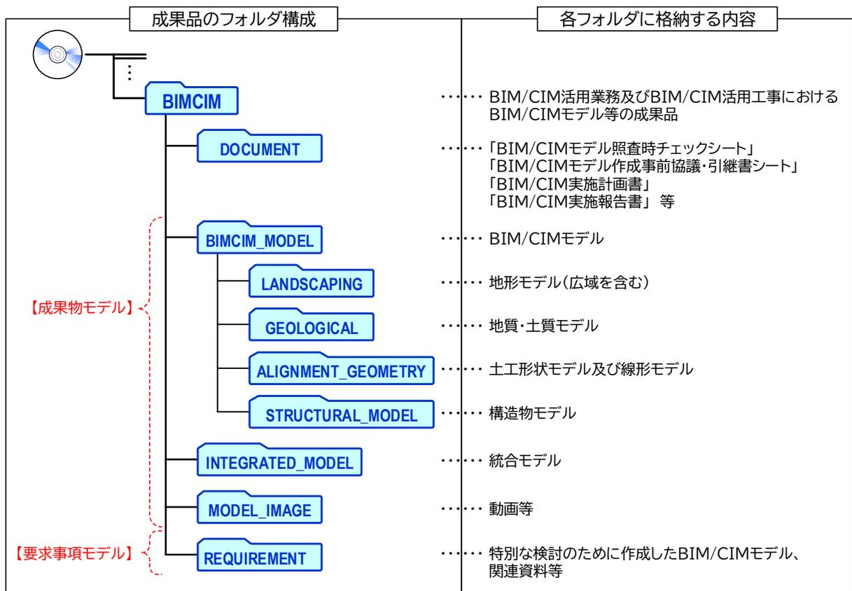
図 2-1 BIM/CIM活用業務およびBIM/CIM活用工事における成果品のフォルダ構成
