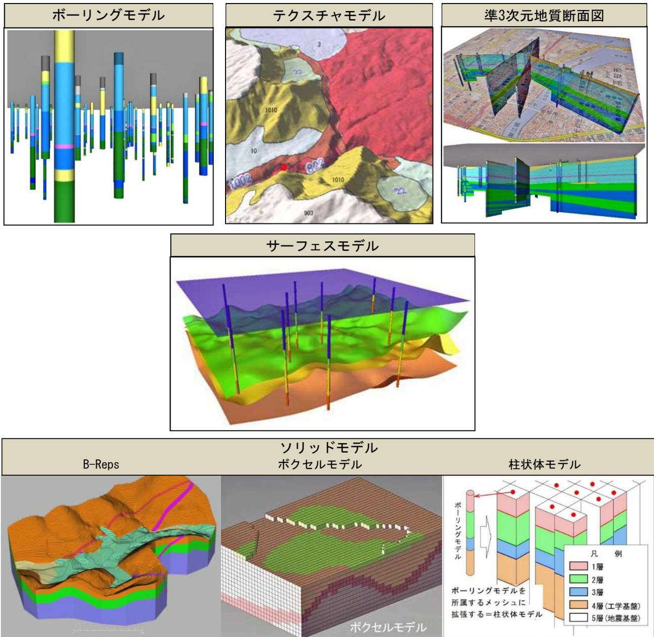
図 2-5 地質・土質モデルの例
