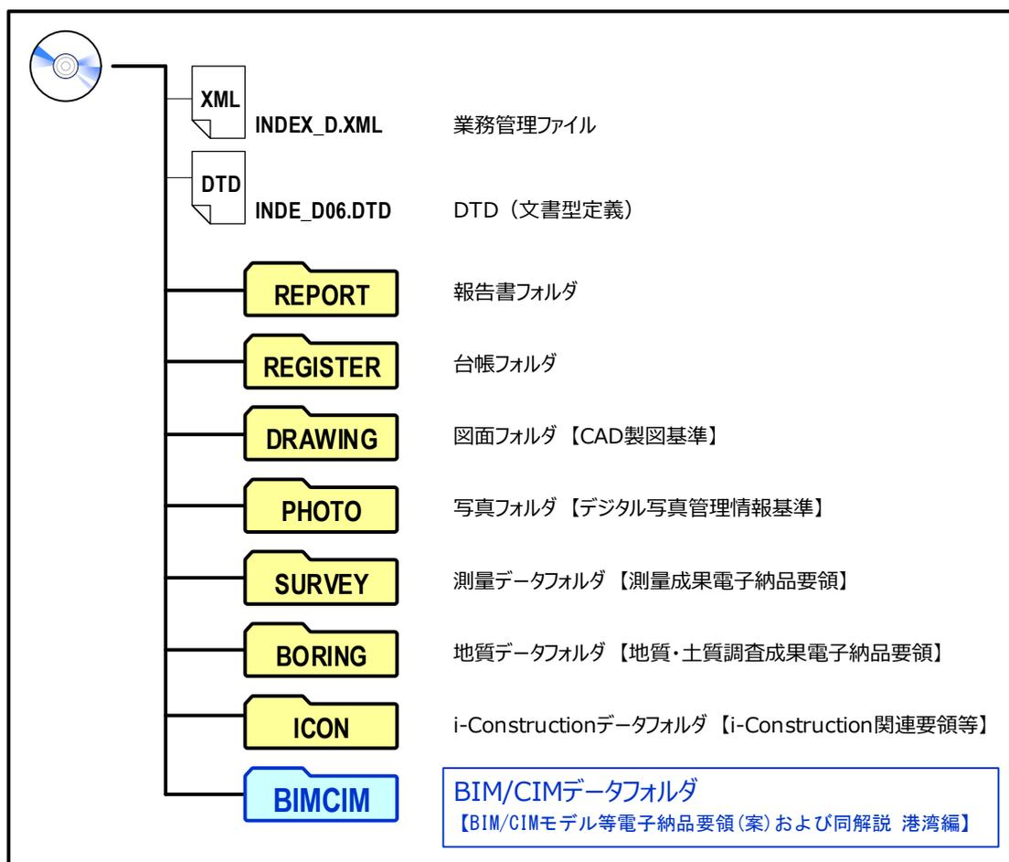
図 1-2 土木設計業務等の電子成果品のフォルダ構成でのBIM/CIMフォルダの位置関係
