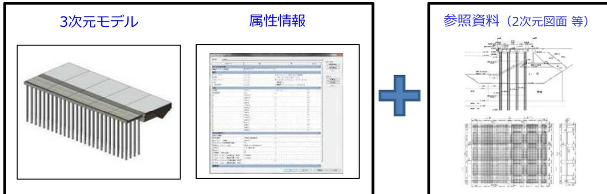
図 2-8 構造物モデルの例
