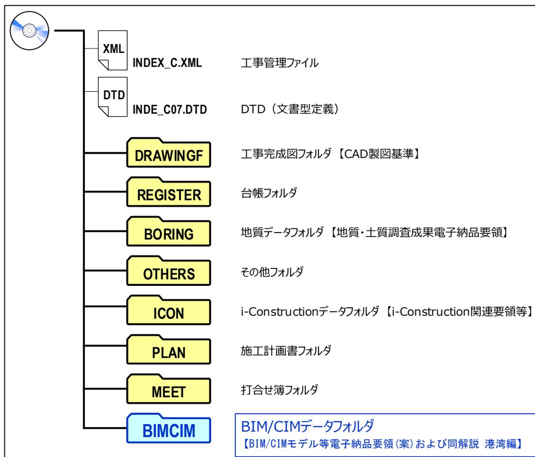
図 1-3 工事完成図書の電子成果品のフォルダ構成でのBIM/CIMフォルダの位置関係
