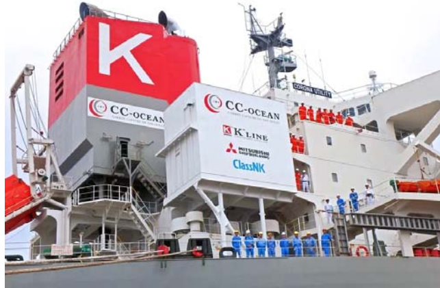
図 5.3-1 三菱造船、川崎汽船、日本海事協会によるプロジェクト： 本船に搭載完了した CO2 回収装置の様子
