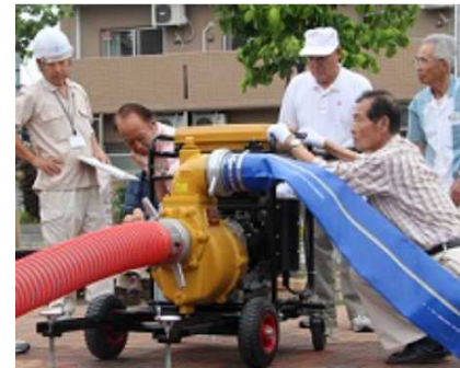
水防用排水ポンプ
