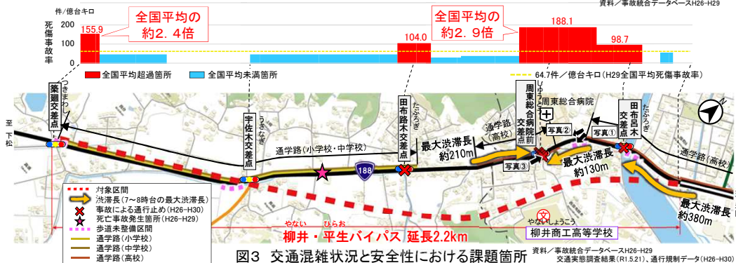
図3 交通混雑状況と安全性における課題箇所
