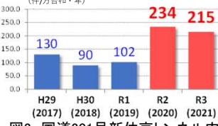
図2 国道201号新仲哀トンネル内の急ブレーキ発生頻度 ※ ETC2.0データ(H29～R2:1年分、R3:1～6月)0.3G～1.0Gを対象
