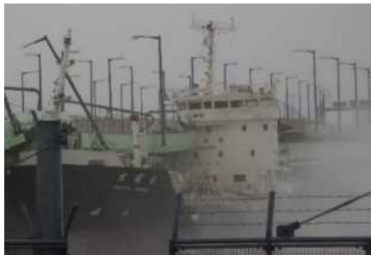
走錨し関空連絡橋に衝突したタンカー
