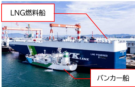
【(図表⑦)バンカー船によるLNGの燃料供給の様子】[提供:セントラルLNGマリンフューエル]
