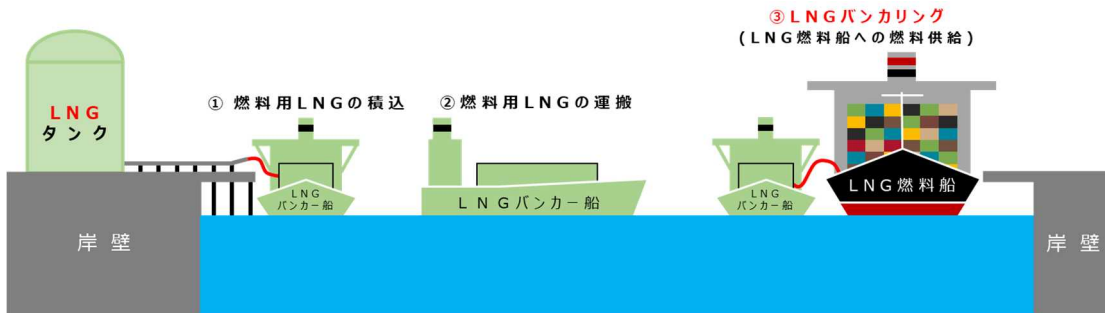
【(図表15) LNGバンカー船による燃料供給のイメージ】〔出典：海上保安庁〕
